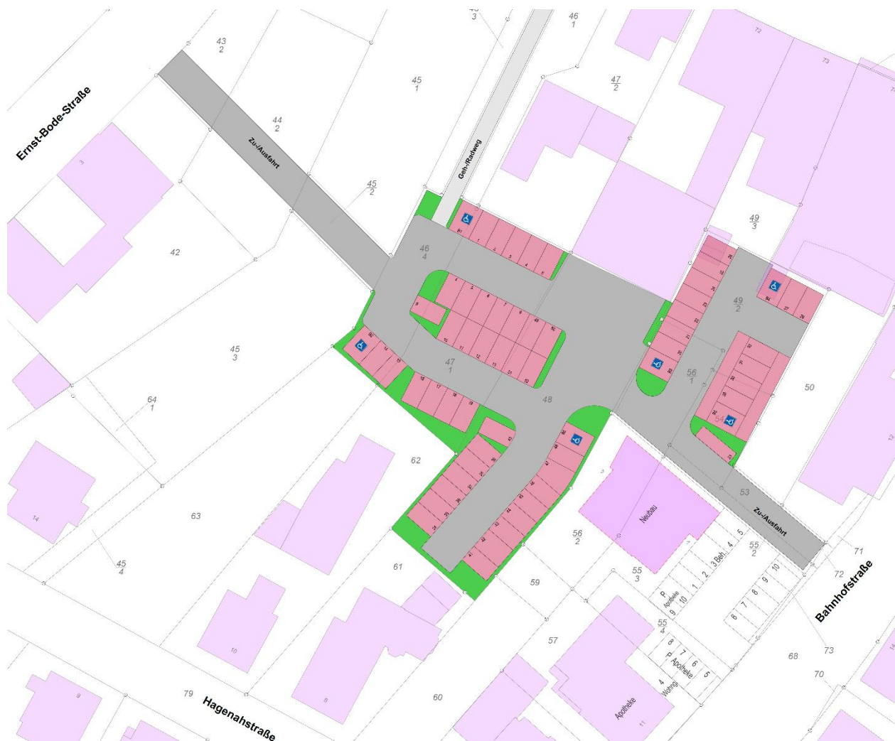
Abb. 9: Stellplatzeinteilungskonzept (ohne Maßstab), Quelle: Ingenieurbüro Schmidt & Rietzke
