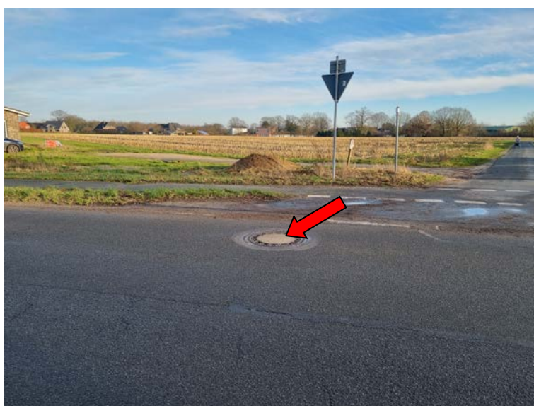
Bild 2: Gewählter Höhenbezugspunkt (HBP = OK Schachtdeckel), Kreuzung Rhedenweg.
