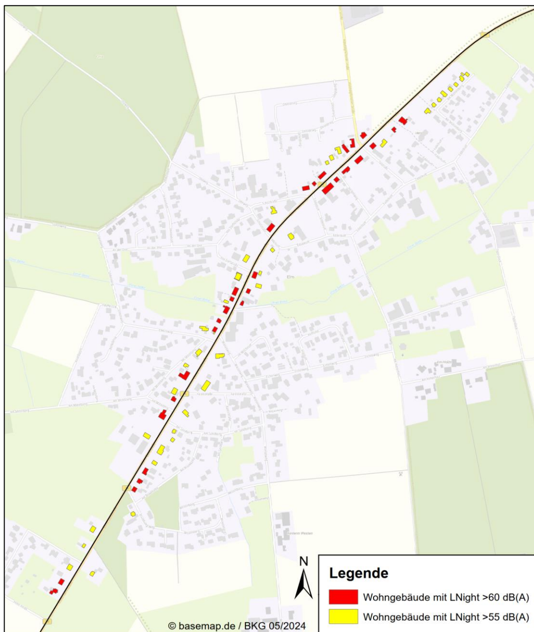
Abbildung 3: Von Umgebungslärm belastete Wohngebäude an der B74 in Elm Quelle: Lärmkartierung 2022/2023 23
